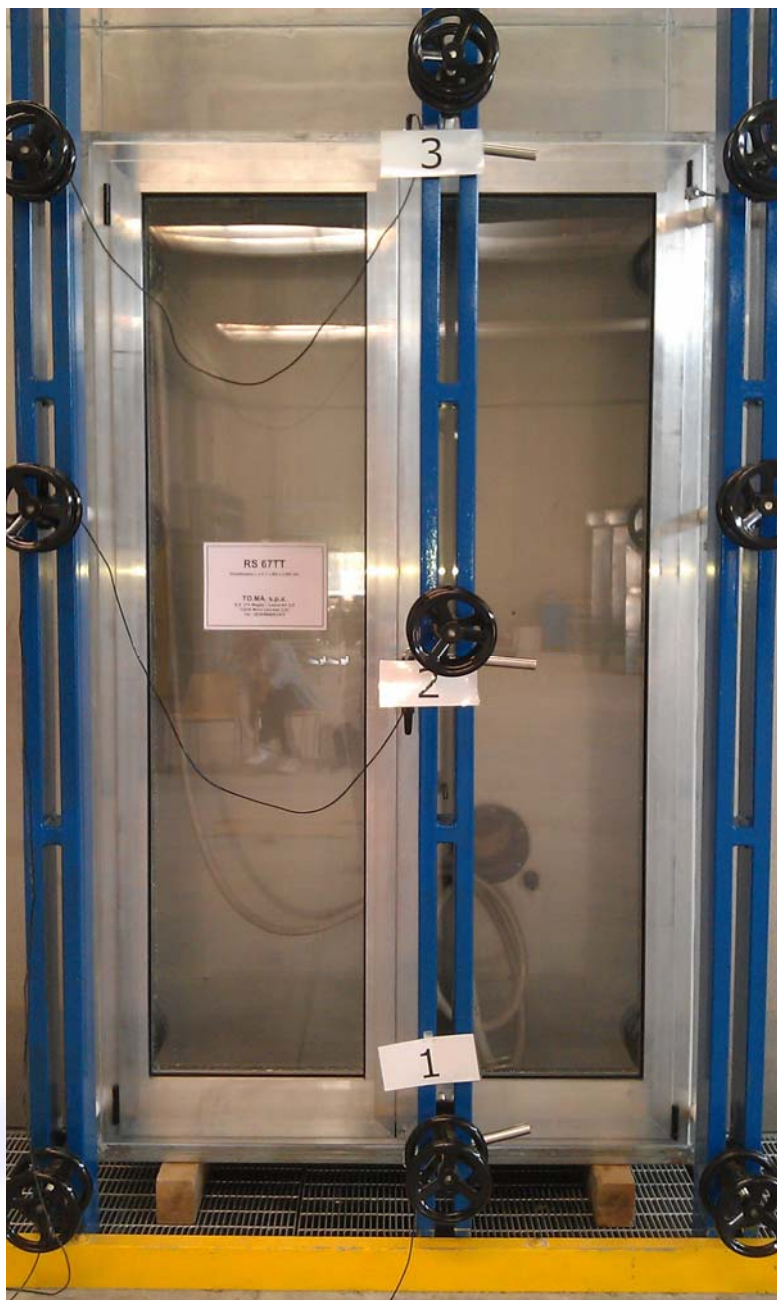
Foto 4: Campione durante la prova di resistenza al carico del vento (prova di deformazione)
