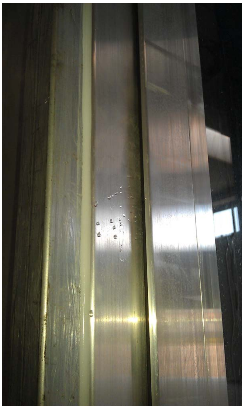
Foto 3: Perdita laterale del campione durante la prova di tenuta all'acqua
