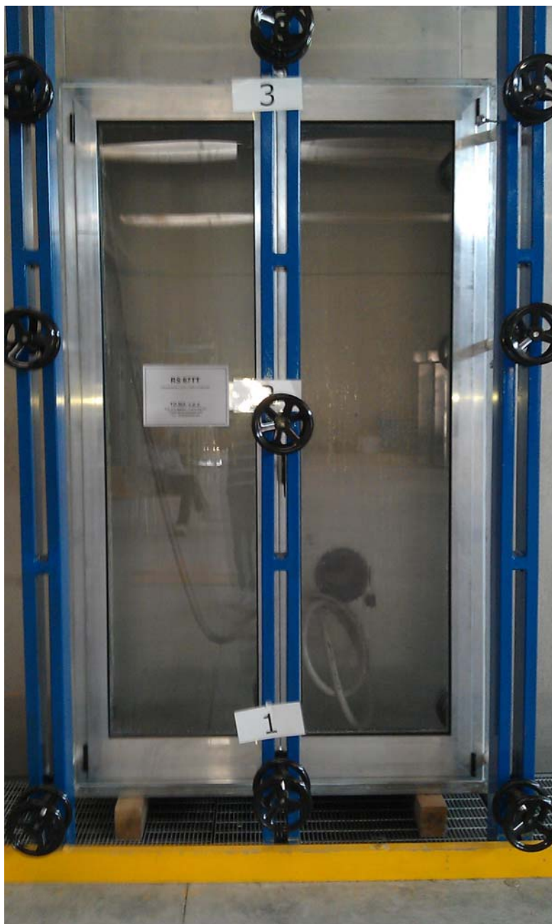
Foto 2: Campione durante la prova di tenuta all'acqua
